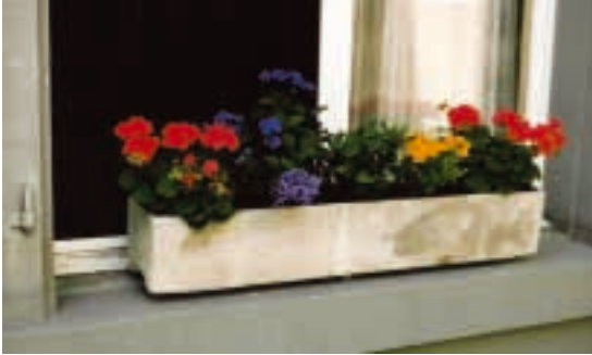
Blumenkisten aus Asbestzement
